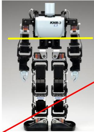
KHR3HVの腰の位置(黄色の線)より上で頭よりしたに腕を取り付けて下さい。腕の取付け位置の画像は切り取っても問題ありません。Autoのダミーロボットの腕は、KHR-3HVの腰の位置(黄色の線)と頭の間にあるようにしてください。
